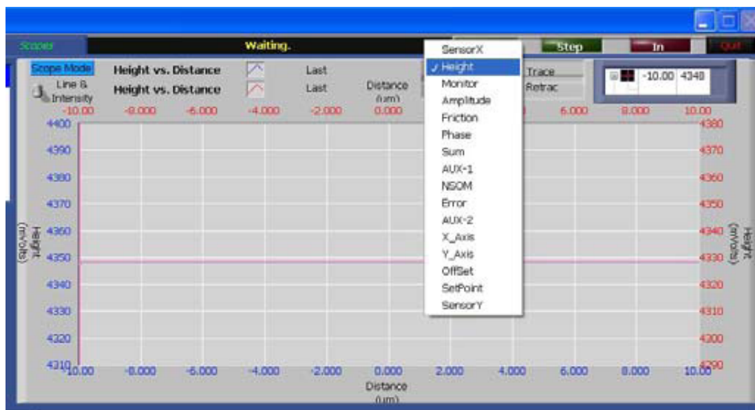
Figura 2.27: Seleção dos canais a serem usados: Height, SNOM, Error, etc.
