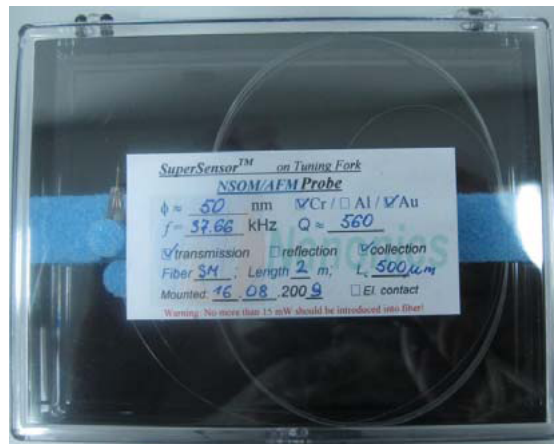
Figura 2.37: Ponteira de SNOM indicando tamanho, frequência de ressonância, fator de qualidade, etc.
