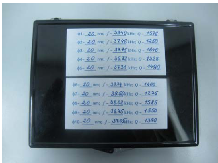
Figura 2.9: Parâmetros das Ponteiros de AFM.
