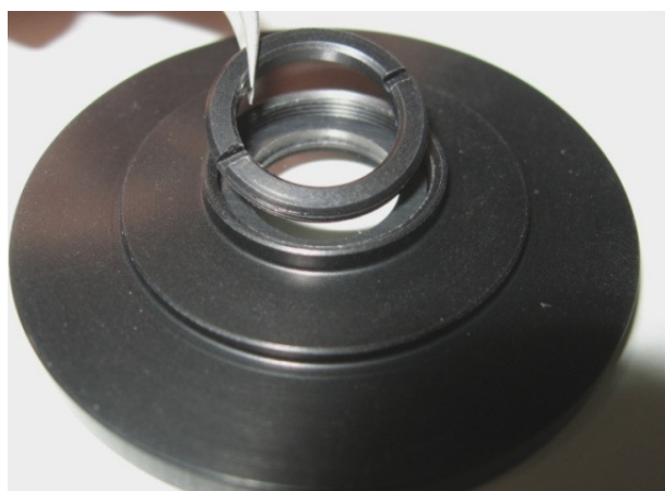
Figura 2.35: Modo de como é inserido o anel de plástico na célula líquida.
