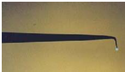
Figura 1.12: Ponteira de Fibra ótica usada para SNOM.
