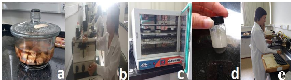
Figura 2: Método de maceração descrito por Franklin (1945): a) Saturação dos corpos de prova; b) Cortes histológicos (8 µm); c) Dissociação dos elementos celulares – Franklin; d) Macerado; e) Lavagem do macerado.
