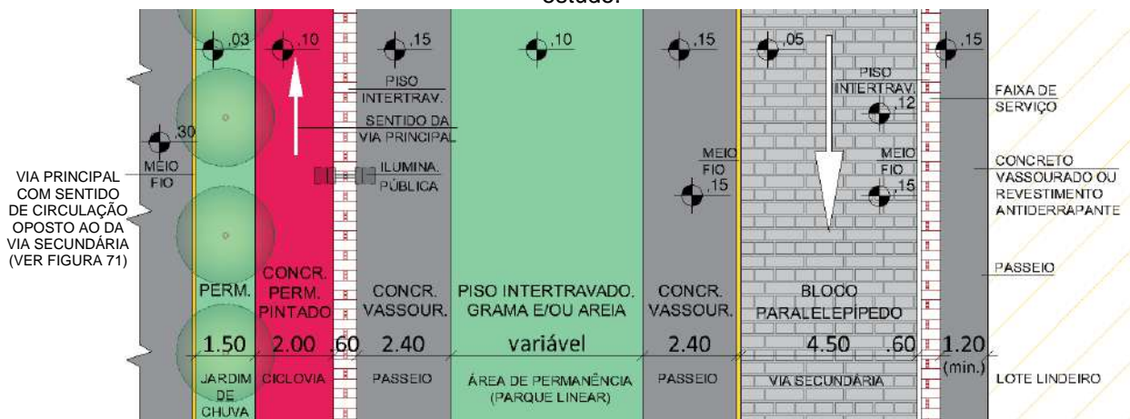
Figura 72: Síntese esquemática (croqui) do padrão de vias secundárias sugerido para a área de estudo.
