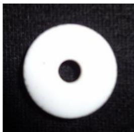
Figura 1- Matriz de teflon individualizada com dimensões de 2 mm de altura por 15 mm de diâmetro, com um orifício central de 4mm de diâmetro
