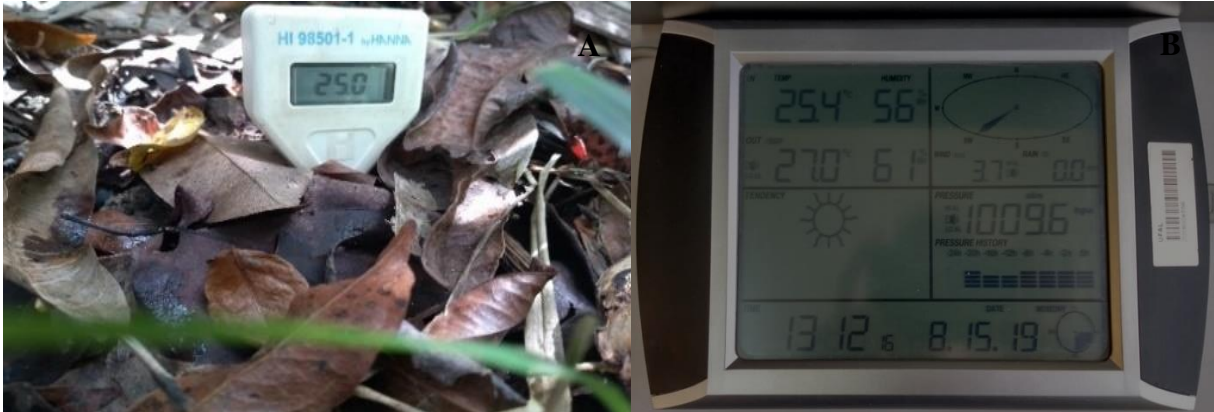
Figura 5 – Medição da temperatura do solo (A) e painel da estação meteorológica (B) do LabESA/IGDEMA/UFAL.
