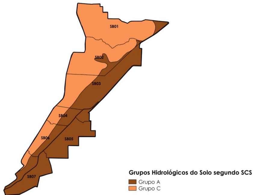
Figura 10: Classificação hidrológica dos solos da Bacia Hidrográfica do Riacho do Sapo seguindo o levantamento detalhado dos solos de Maceió (EMBRAPA, 2005).
