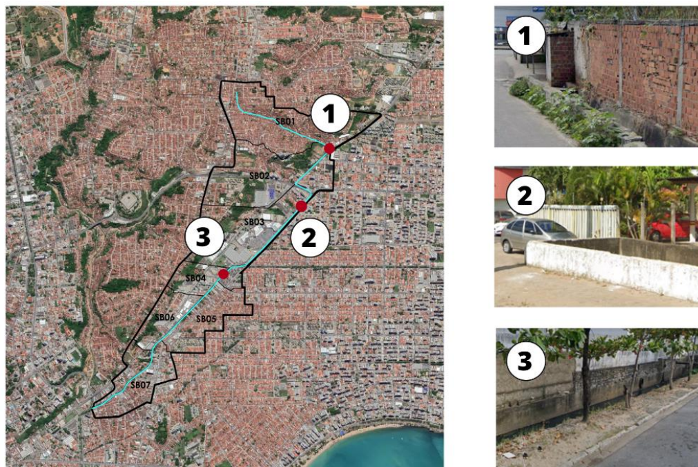
Figura 31: Localização dos pontos de alagamento observados na simulação do SWMM na bacia do riacho do Sapo.
