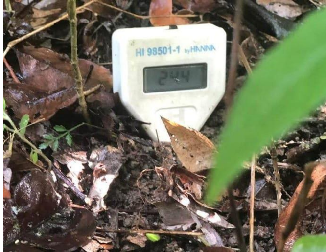
Figura 8 - Medição da temperatura na superfície do solo (0-10 cm), utilizando termômetro digital espeto.
