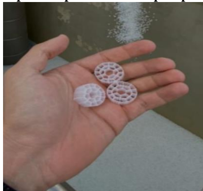
Figura 4 - Suporte plástico para biofilme típico para MBBR.
