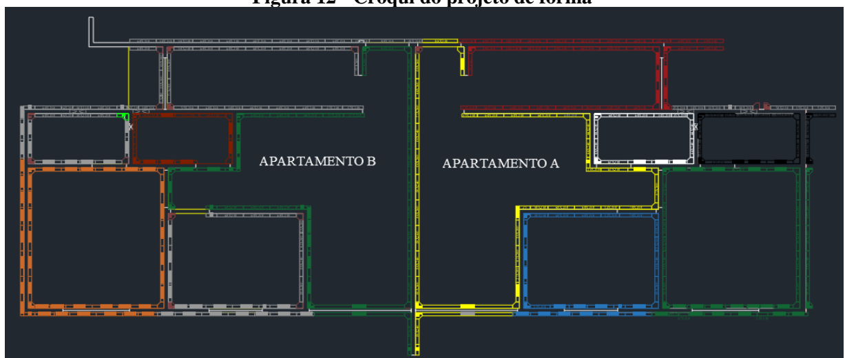
Figura 12 - Croqui do projeto de fôrma
