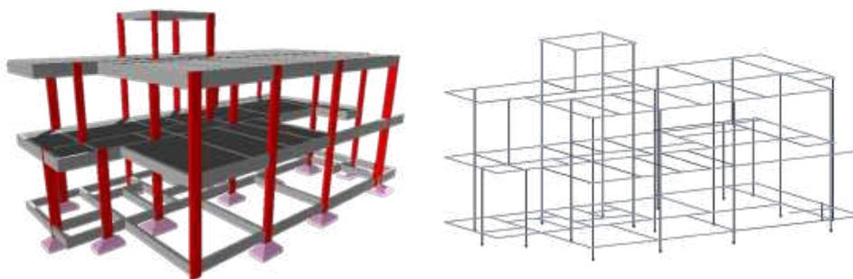
Figura 9 – Modelo 3D de uma estrutura em concreto armado e sua respectiva discretização na forma de pórtico espacial.
