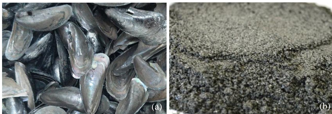
Figura 11 – Concha de sururu: (a) pirolisada; (b) pirolisada e triturada
