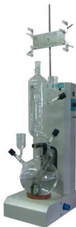
**Figura 10.** Redutec – Aparelho para análise de açúcares redutores e acidez volátil. **Fonte:** Marconi, 2018.
