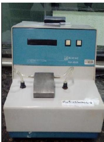
**Figura 09.** Refratômetro digital Modelo RDA 8.500 ACATEC utilizado para determinação do Brix nas análises de caldo de cana. **Fonte:** Autor, 2018.
