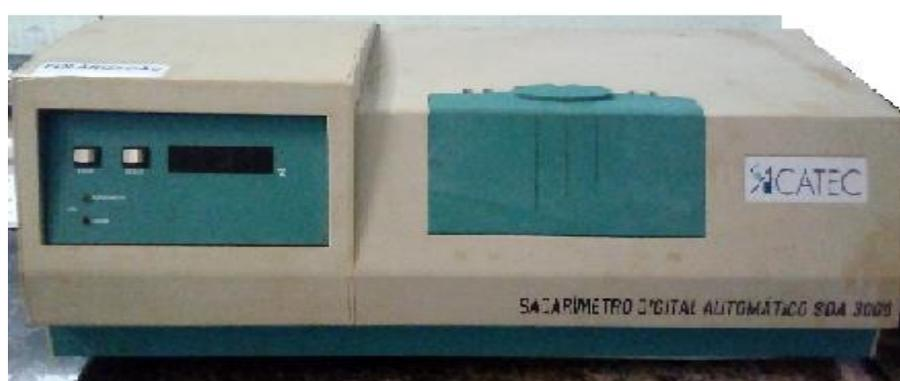
**Figura 08.** Sacarímetro Modelo SDA 3.000 ACATEC com dupla rotação óptica em graus  $Z^\circ$  ou  $S^\circ$  para determinação da sacarose aparente. **Fonte:** Autor, 2018.
