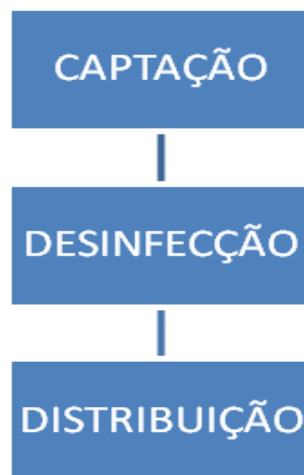
Figura 02 – Fluxograma das etapas de tratamento realizadas pelo Departamento de Água e Esgoto de Coruripe
