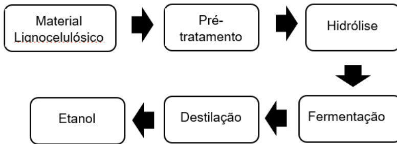
Figura 6: Processo simplificado da produção do etanol de 2ª geração
