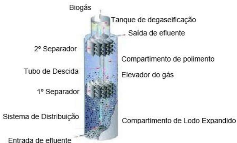
Figura 8 – Reator IC anaeróbico internamente
