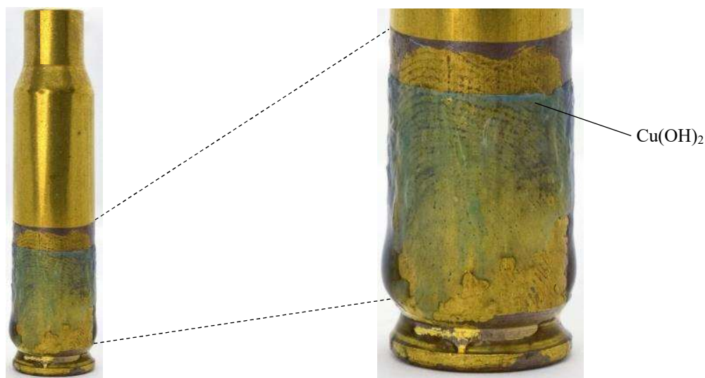
Figura 34 - Precipitado de \text{Cu}(\text{OH})_2 em estojo de munição.
