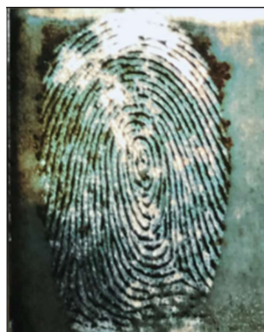
Figura 29 - Cronoamperograma e impressão digital de 7 dias revelada por eletrodeposição de PPy com E = 0,75 V vs. Ag/AgCl (KCl sat.) por 60 s.
