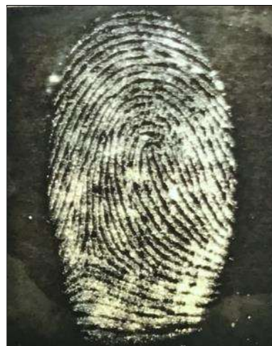
Figura 28 - Cronoamperograma e impressão digital de 24 horas revelada por eletrodeposição de PPy com E = 0,85 V vs. Ag/AgCl (KCl sat.) por 70 s.
