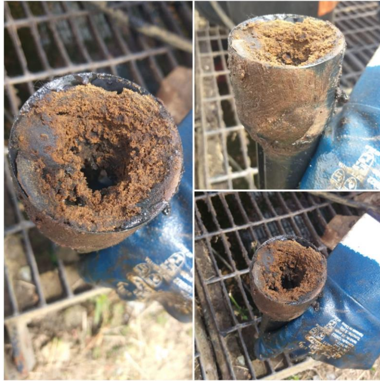
Figura 28: Parafina Retirada de uma Coluna de Produção.
