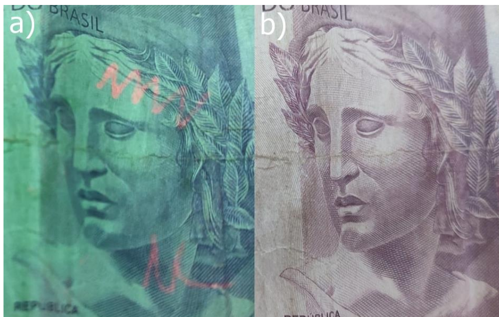
Figura 42 - Detalhe de uma nota de 5 reais riscada com a caneta de emissão de luz vermelha EuBDC PVP5 a) sob irradiação de luz UV (254 nm) e b) sob à luz do dia.
