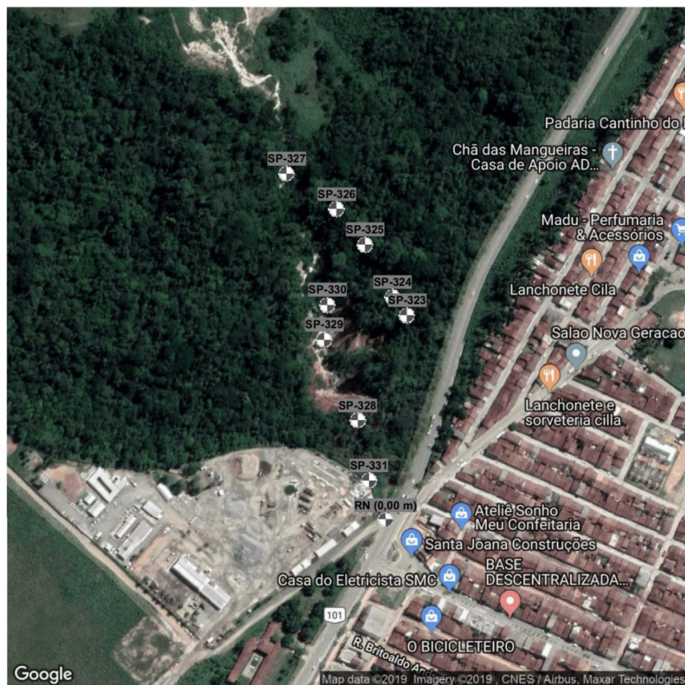
Figura 08: Croquis de localização das sondagens existentes.
