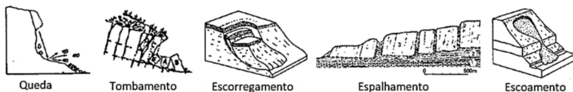
Figura 03: Tipos de rupturas em taludes
