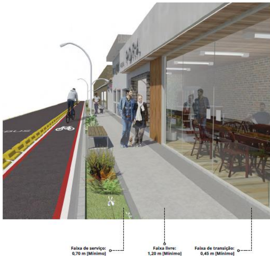
Figura 34- Esquema com larguras recomendadas para calçadas. Fonte: Caderno técnico para projetos de mobilidade urbana, 2016
