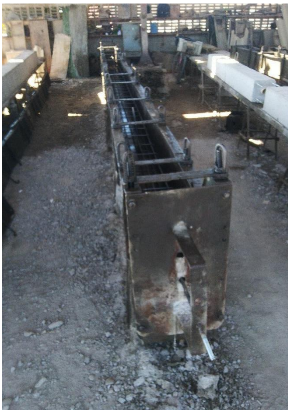
Figura 9 - Fôrma metálica para concreto pré-moldado
