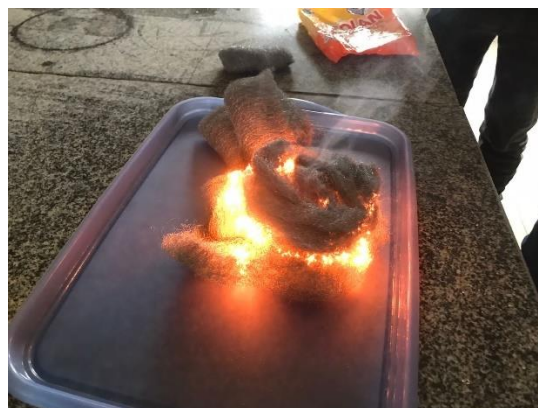
Queima da palha de aço para produção de óxido de ferro III ( \text{Fe}_2\text{O}_3 ).
