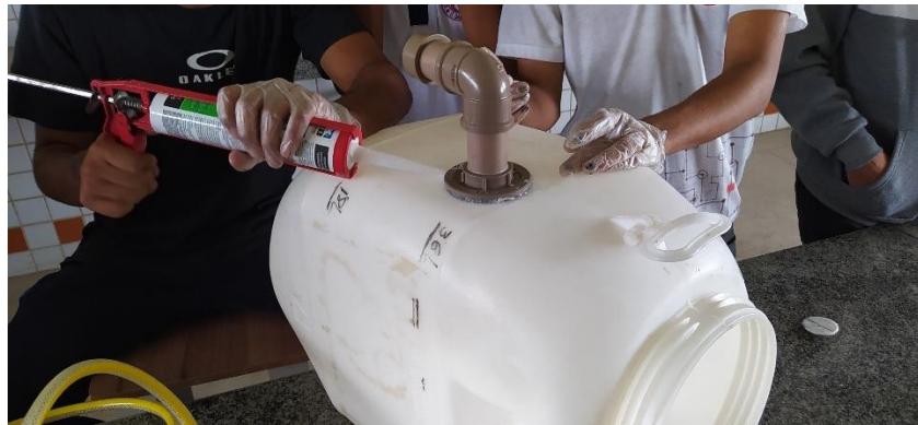
Imagem 13: Montagem e vedação da saída do biofertilizante.
