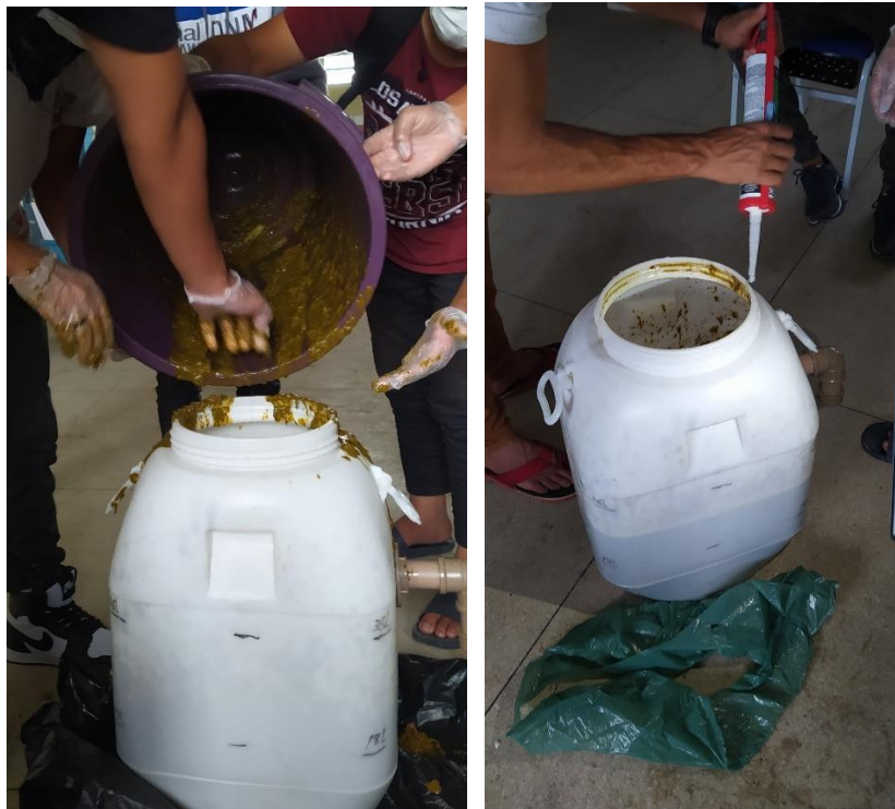
Imagem 15 e 16: Alimentando a câmara de digestão / Aplicando o silicone para vedação.
