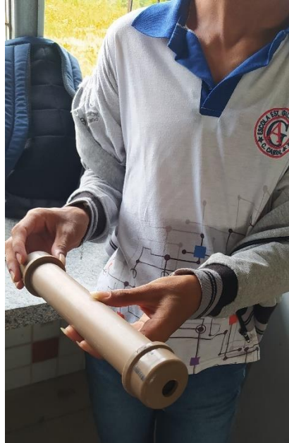
Imagem 19: Filtro de PVC preenchido com óxido de ferro III ( \text{Fe}_2\text{O}_3 ) para retirada de gás sulfídrico ( \text{H}_2\text{S} ).
