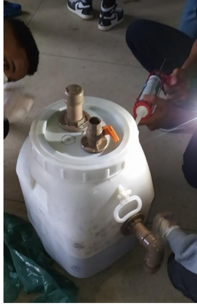
Imagem 17: Finalizando a vedação câmara de digestão.
