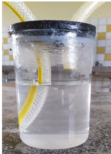
Imagem 21: Borbulhador para retirada de dióxido de carbono ( \text{CO}_2 )
