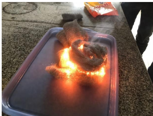
Imagem 18: Queima da palha de aço para produção de óxido de ferro III ( \text{Fe}_2\text{O}_3 ).
