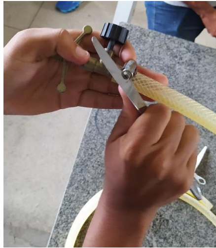
Imagem 22: Instalação do bico queimador.
