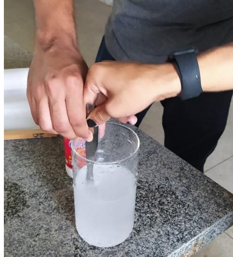
Imagem 20: Produção da solução de hidróxido de sódio ( \text{NaOH} ) a 1,87 M.
