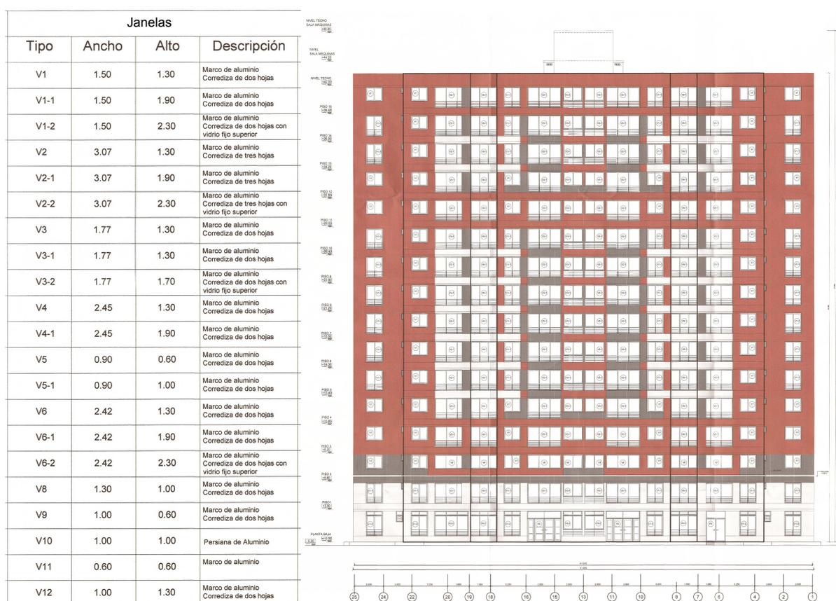
**Figura 13.** Detalhamento das janelas e fachada principal do Caso Modelo
