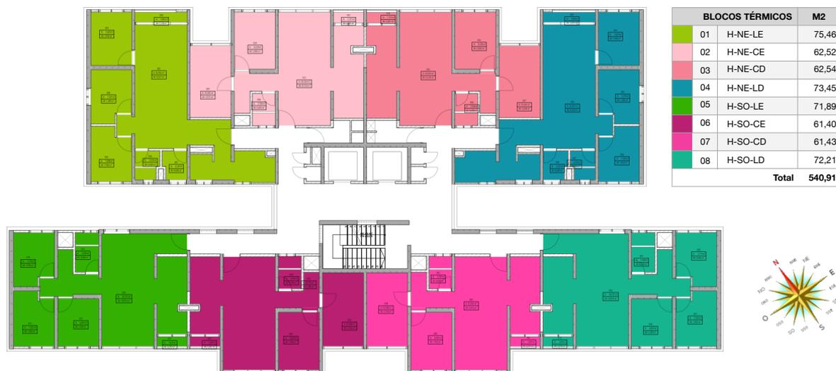
**Figura 14.** Blocos térmicos trabalhados na simulação
