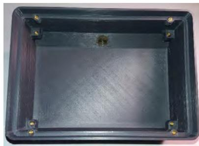
FIGURA 11 – Visualização interna da tampa da caixa após a impressão realizada através da impressora Ender 3 Pro. Os pinos dourados são utilizados para fixar a PCB através de parafusos a estrutura.
