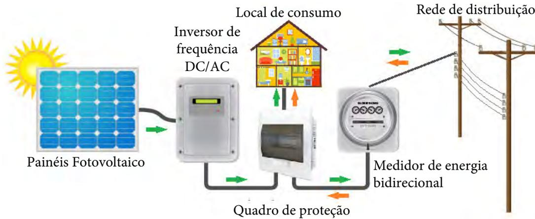
Figura 6: Conceito básico da geração de energia através dos painéis fotovoltaicos e sua injeção a uma rede de distribuição. Fonte: Adaptado de (SENERGAM, 2022)
