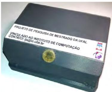
FIGURA 10 – Visualização externa da tampa da caixa após a impressão realizada através da impressora Ender 3 Pro. O adesivo indicando que o equipamento foi utilizado para pesquisa de mestrado junto a universidade, no qual foi colocado posteriormente.
