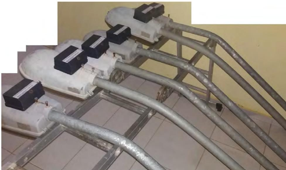
FIGURA 01 - Perspectiva das luminárias com os relés de telegestão instalados acima.
