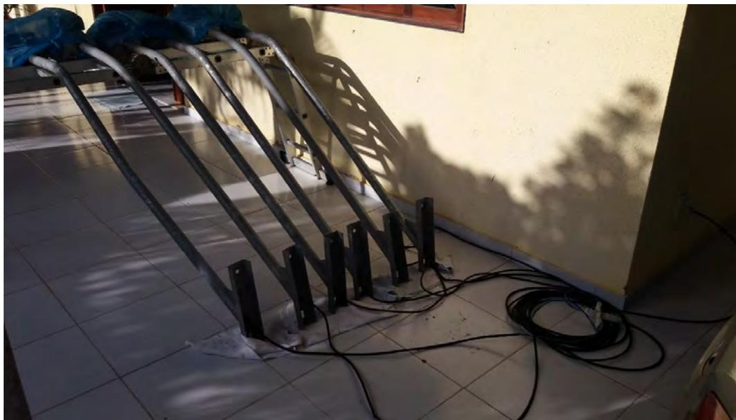
FIGURA 04 – Luminárias com os relés de telegestão ligadas no mesmo ponto de energia e na mesma fase do analisador de energia modelo PowerNET P-600 G4 do fabricante IMS.
