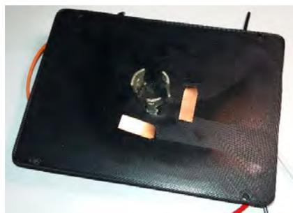
FIGURA 13 – Visualização inferior da base da caixa após a impressão realizada através da impressora Ender 3 Pro com alguns componentes e terminais elétricos instalados.
