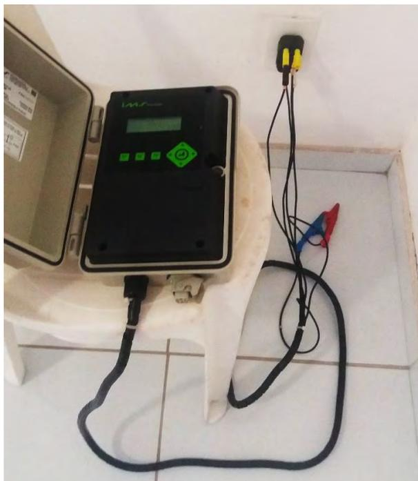
FIGURA 03 – Analisador de energia utilizado para realizar o monitoramento das tensões na rede de distribuição, bem como para calibrar um dos relés, assim como para verificar os erros de medição de todos os relés com relação a este analisador.
