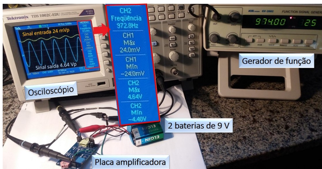
Figura 50 – Teste da placa amplificadora utilizando o osciloscópio e o gerador de função.
