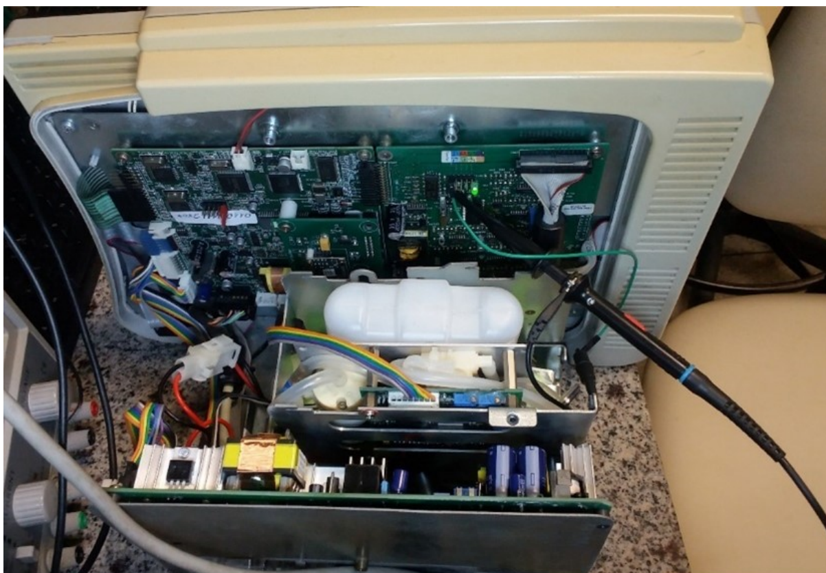
Figura 64 – Mostra o ponto de medição do sinal processado pelo monitor de ECG.
