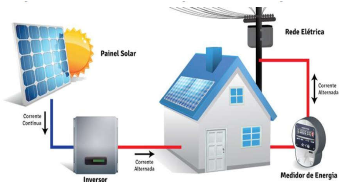
Figura 4 - Exemplo de sistema de painéis solares interligados à rede da concessionária
