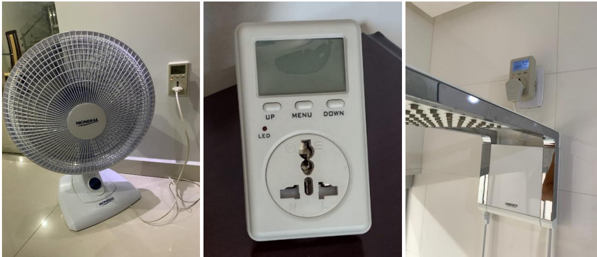
Figura 26 - Amperímetro digital usado em auditoria energética
