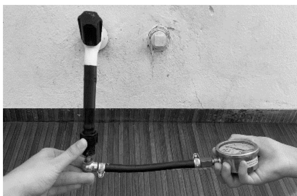
Figura 57 - Medição de Pressão de chegada de água (uso de manômetro)
