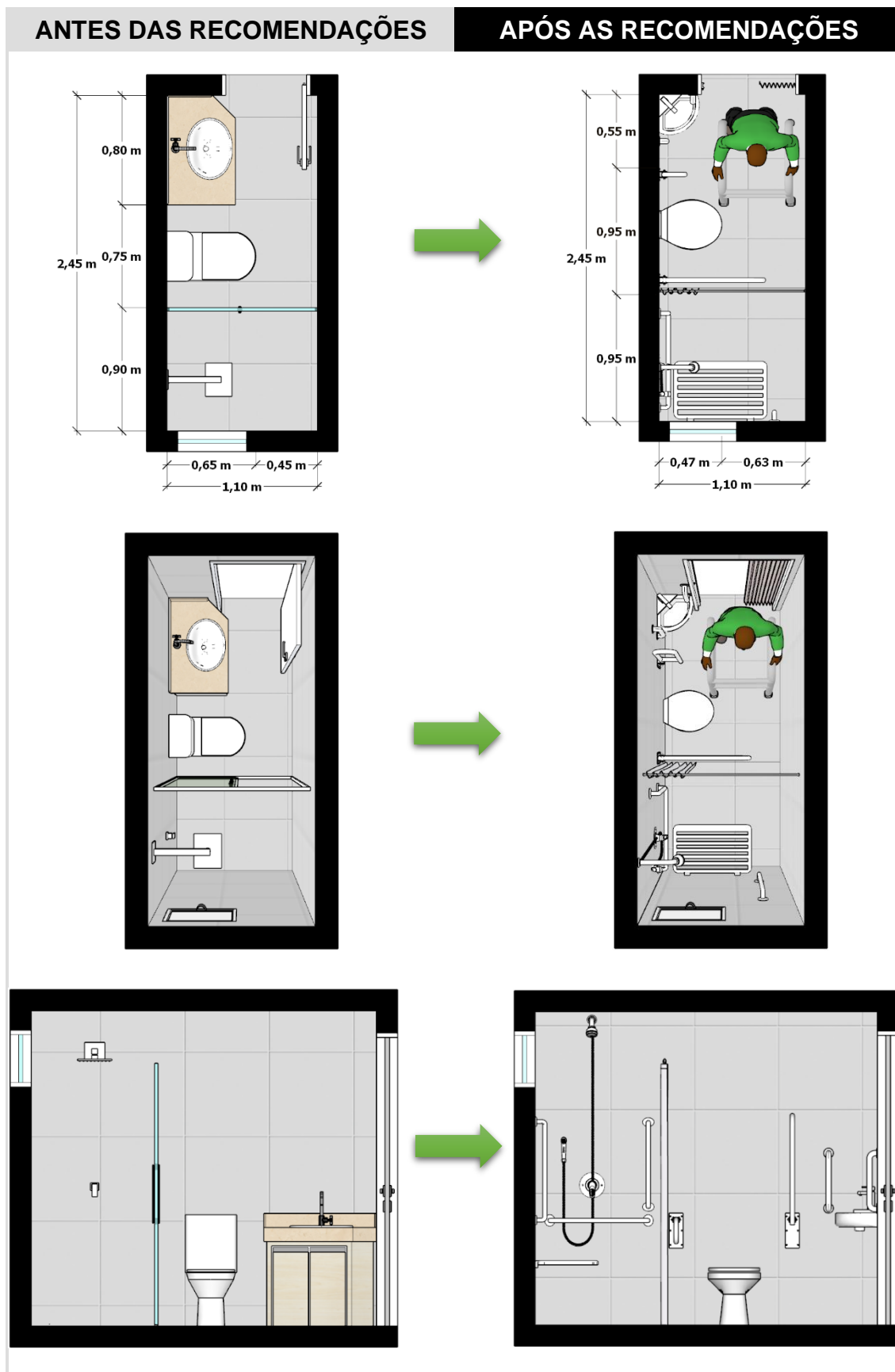
QUADRO 10 –Banheiro social do edifício Promenade antes e após recomendações de projeto.
