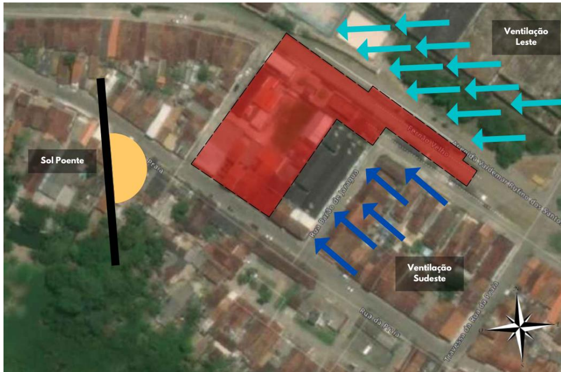
Figura 108- Estudo de insolação e ventilação do terreno.
