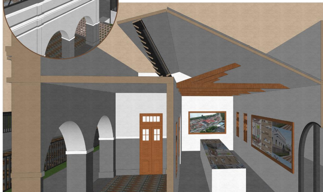
Figura 132- Corte esquemático - Shed da galeria expositiva 1.
