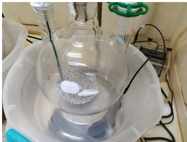
Figura 27 - Disposição dos sensores de temperatura no reator.
