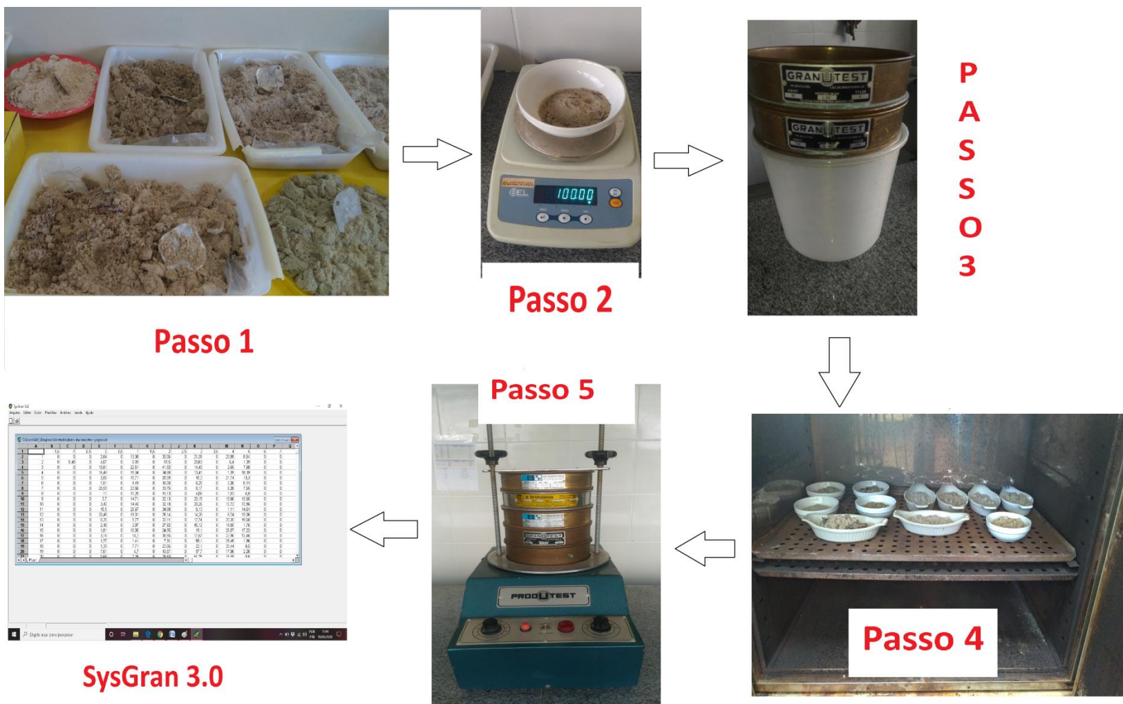
Figura 41 – Fluxograma do processo de classificação das amostras.
