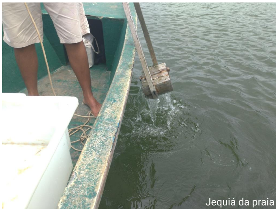
Figura 40 – Coleta de sedimento com amostrador do tipo Van Veen.
