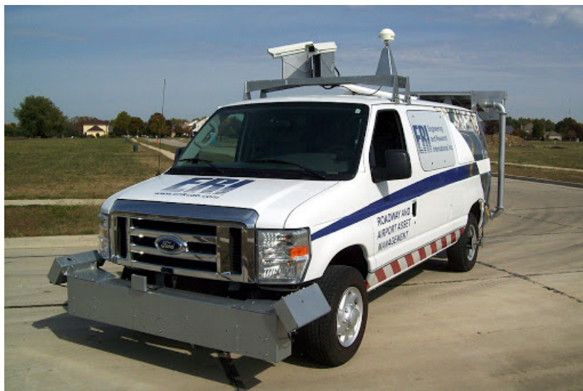
Figura 3: Veículo para classificar o IRI. Fonte: [Engineering & Research International 2021]
