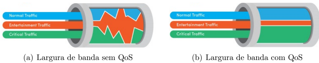
Figura 2.2: Comparativo de uso da largura de banda em redes sem e com suporte QoS 1
