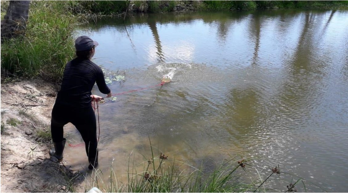
Figura 7 – Lançamento da rede de fitoplâncton em arrastos horizontais.
