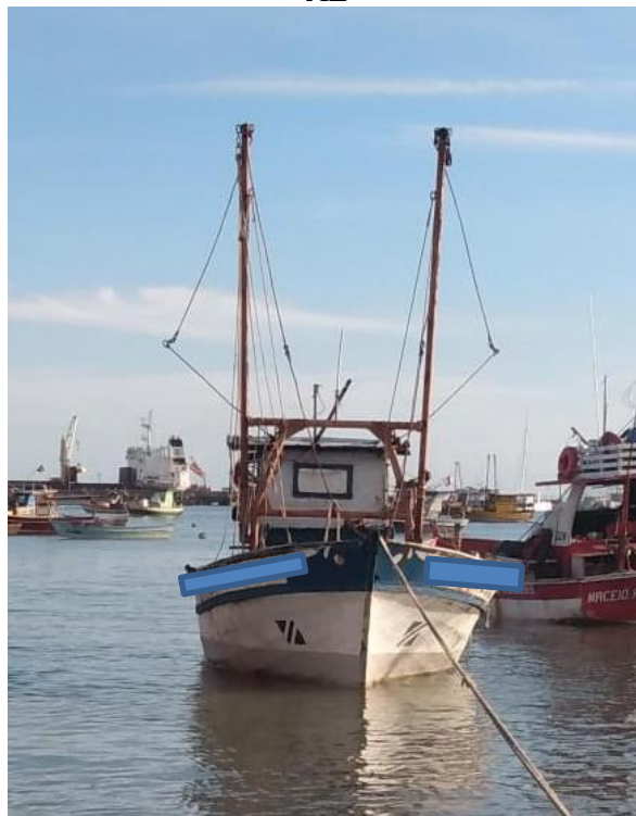
Figura 5: Barco de médio porte com tangones, utilizado na pesca de arrasto de camarões em Maceió-AL
