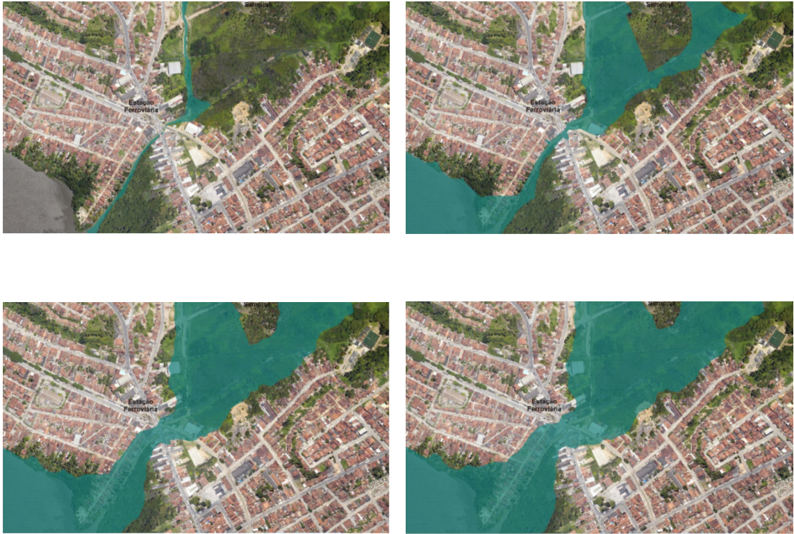
Figura 52 - Simulação de áreas de inundação na região da foz do riacho em caso de ocorrência de cheia
