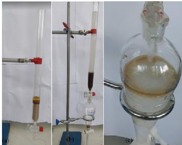
Figura 41: Teste de eficiência com Fluido 2 nas etapas de (a) impregnação da areia com o óleo em estado inicial, (b) geração de coluna com fluido injetado, (c) fluidos recuperados no funil de decantação.
