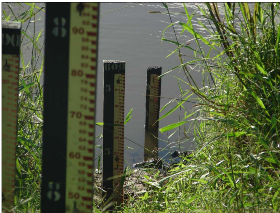
Figura 4.5 – Réguas limnimétricas da estação da Fazenda Boa Fortuna.
