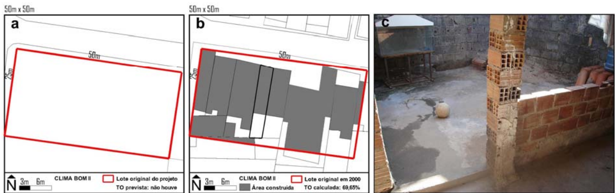
Figura 47 – (a) Lote original do loteamento Clima Bom II; (b) Lote da amostra com grande área construída; (c) Quintal 100% impermeabilizado do lote destacado em preto na figura (b).
