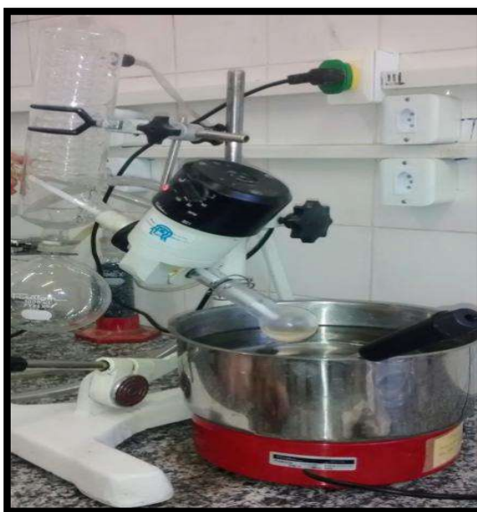
Figura. 14 – Evaporação para obtenção do extrato de própolis vermelha em rotoevaporador no LAFA/ESENFAR/UFAL.
