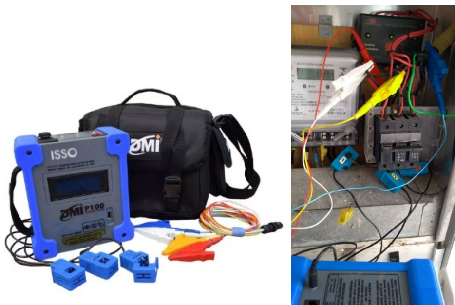
Figura 12 - Analisador de qualidade de energia: Analisador do modelo DMI P100; b) Analisador instalado ao quadro geral da UC1.
