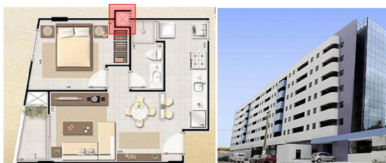
Figura 19 – Poço de luz em edifício da cidade de Maceió - NEO. Fonte: CIPESA/GAFISA, 2010.
