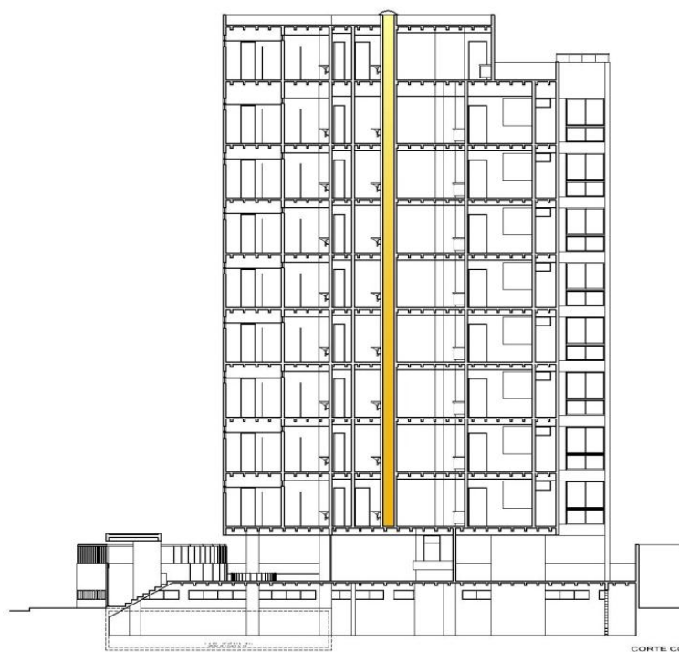
Figura 45 - Corte do Edifício Chateau Lafite com destaque do poço de luz em amarelo. Fonte: Construtora Lima Araújo, 2009.
