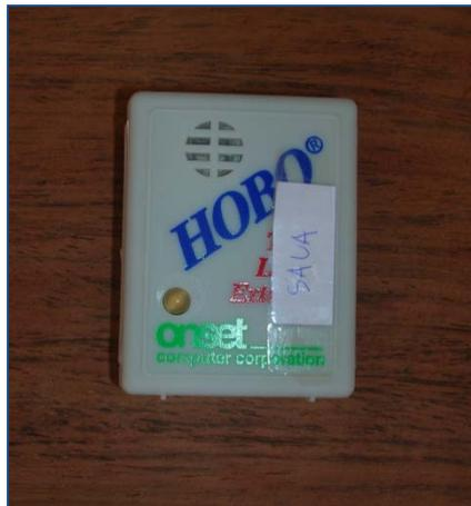
**Figura 11** – Aparelho de medição Hobo utilizado nas medições.
