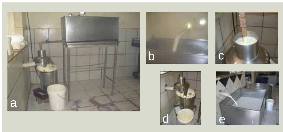
Figura 5.13- Processo de desnate do leite.
