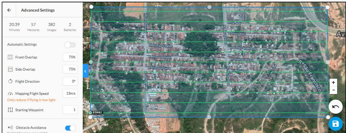
Figura 3 – Planejamento do voo no software DroneDeploy®
