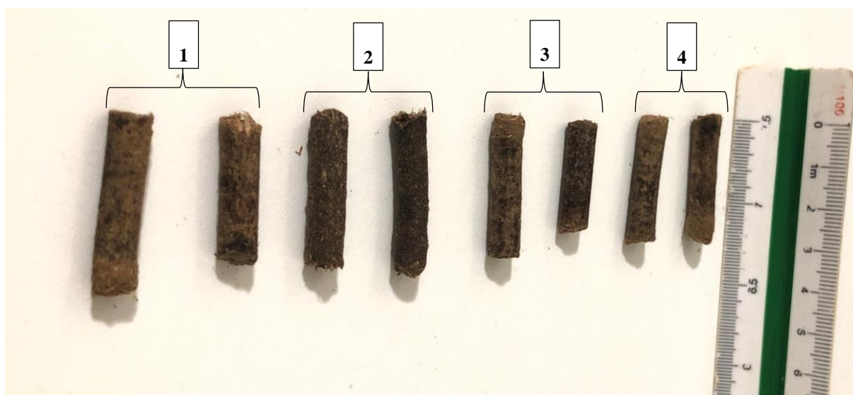
Figura 13: Pellets produzidos amostras 1 à 4.
