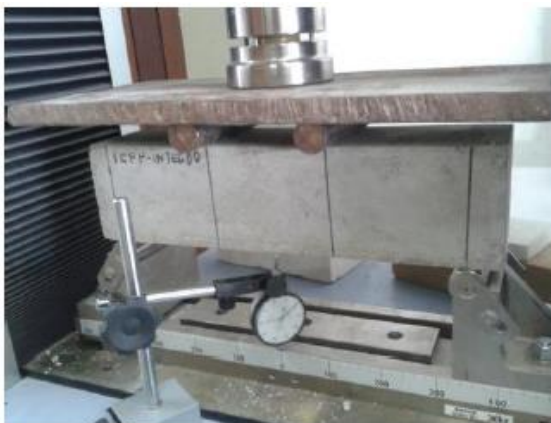
Figura 7 - Ilustração do aparato experimental para a realização do ensaio de flexão em quatro pontos com o posicionamento do relógio comparador analógico.
