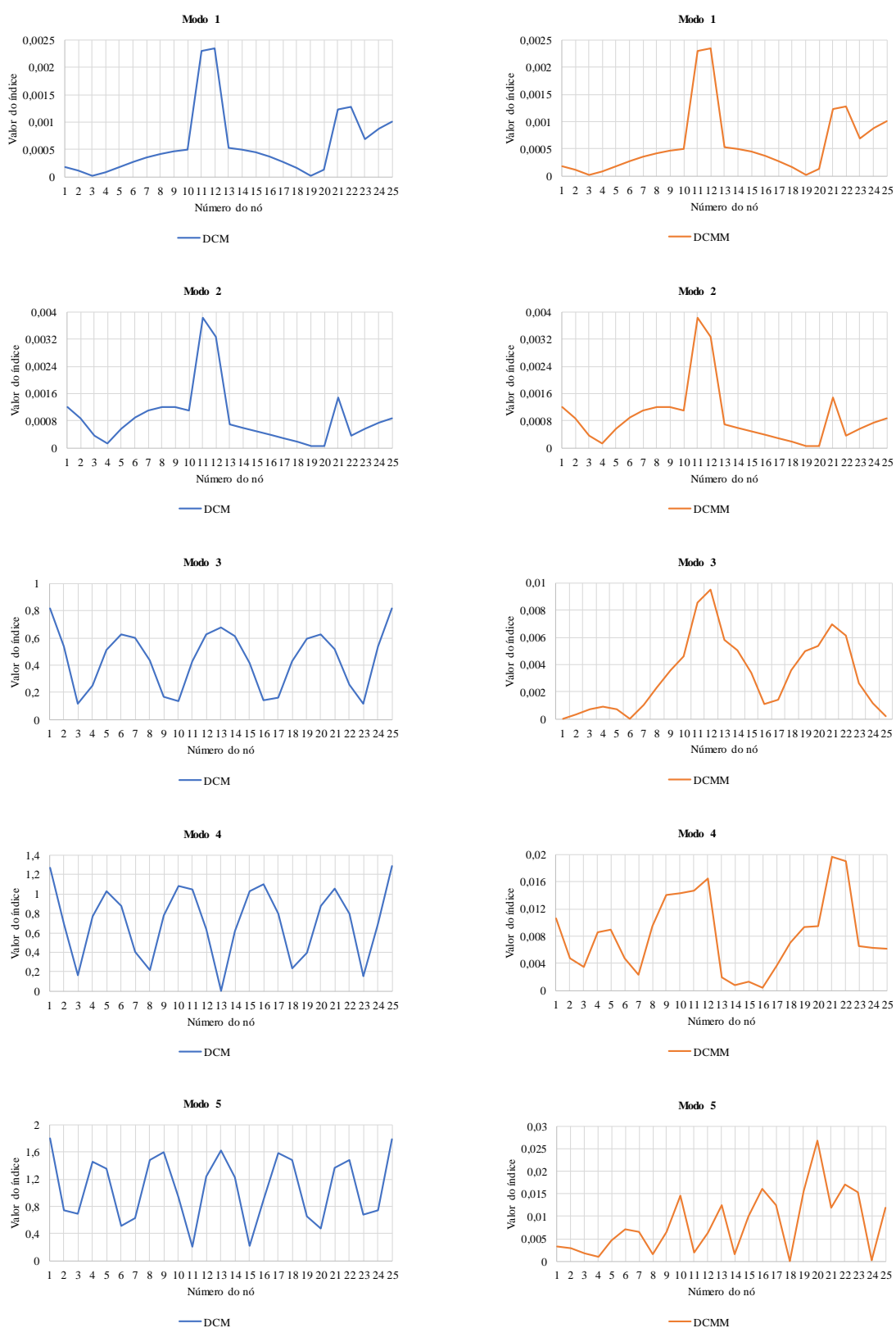
Figura 49 - Aplicação dos métodos DCM e DCMM para os primeiros 5 modos de vibração, em modelo da viga biengastada (Discretização II) com perdas de rigidez à flexão de 10% e 10%.
