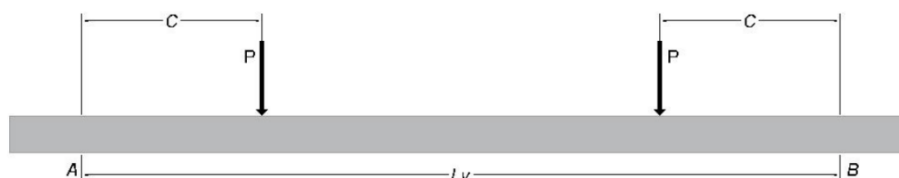
Figura 6 - Esquemática do ensaio de Flexão em quatro pontos.
