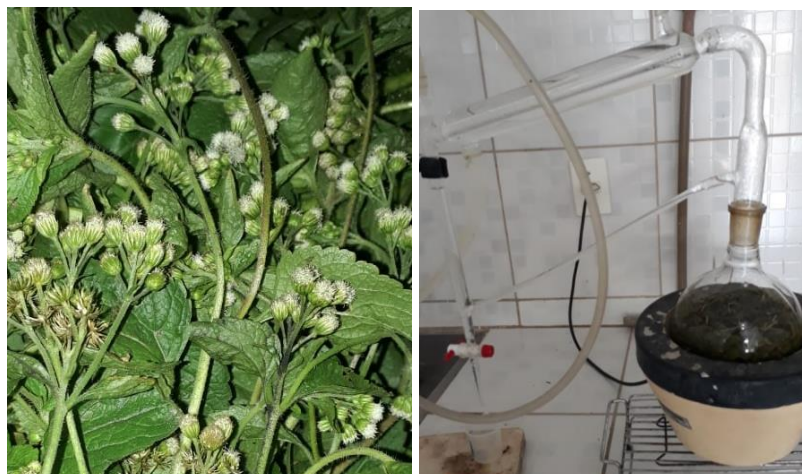
Figura 2. Ageratum conyzoides e aparelho tipo Clevenger
