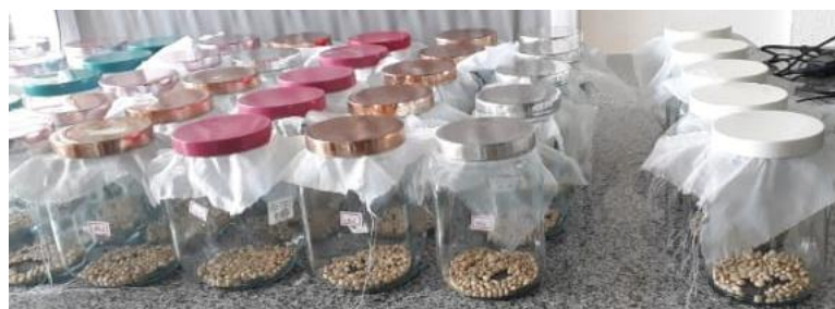
Figura 3. Câmaras de fumigação sem e com grãos.
