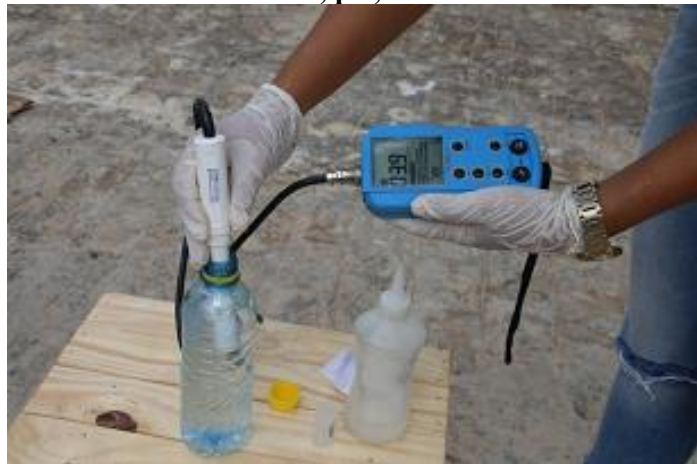
Figura 12 - Análise de Condutividade elétrica, pH, sólidos totais dissolvidos e temperatura.
