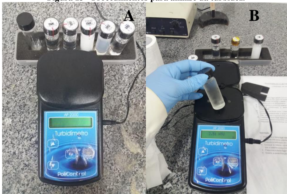
Figura 13 - Procedimentos para análise da turbidez.
