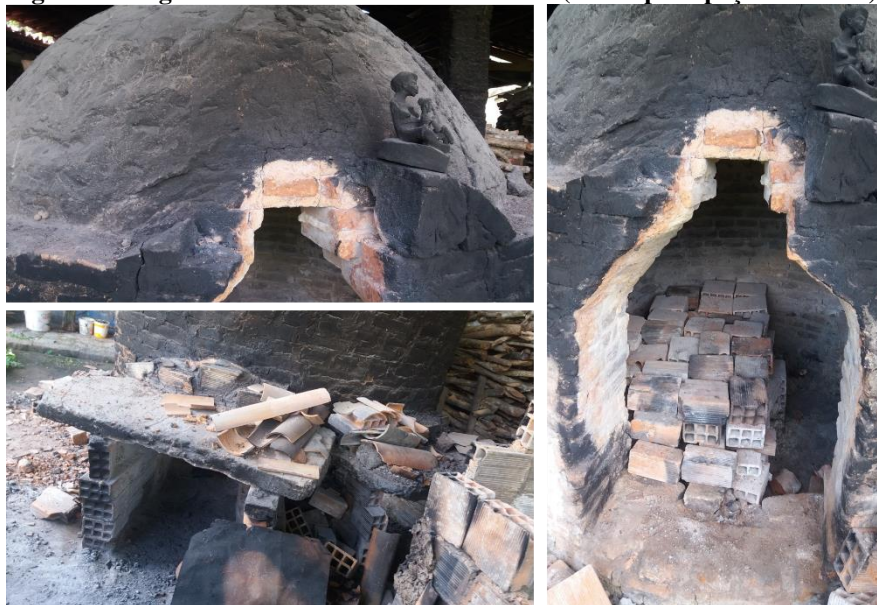
Fig. 4.10 – Segundo forno secundário da Oficina (usado para peças menores).
