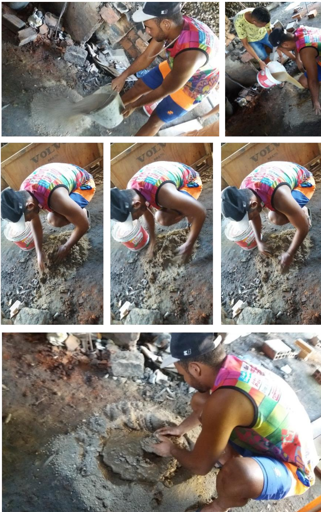
Placa XVI – Em paralelo às buscas pelos tijolos, os ajudantes (contratados especialmente para este fim , de cuidar da queima), começam a preparar a massa para fechar o forno (se revezam nesta atividade de pegar tijolo e preparar a massa). Usa-se pó-de-barro (resíduos da peneirada) e quaisquer outros restos não adequados para modelagem. Estes vão sendo misturados com água, ao lado do forno.
