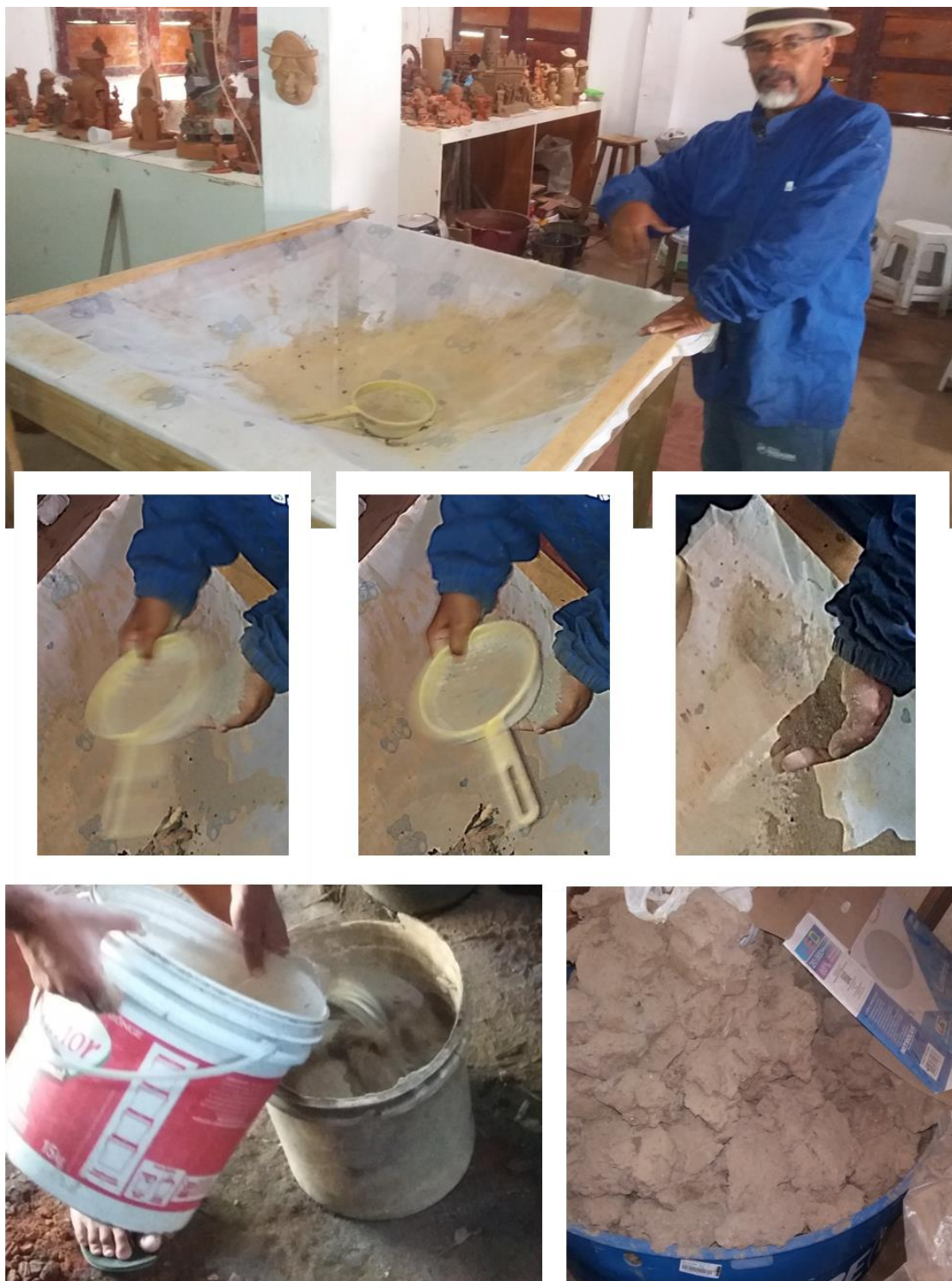
Placa V – A preparação do barro segue várias etapas. Da secagem, após a extração, pisar com um pilão (ou bater com uma madeira em forma de madeira) para fragmentar o material até se transformar em pó que será peneirado usando peneiras de plástico e/ou telas para então gerar a base em pó que será misturada com água e formar uma pasta que será colocada em formas para voltar a secar e atingir a consistência desejada para o trabalho.
